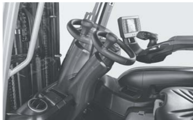
Ajuste da coluna de direção para cima ou para baixo
