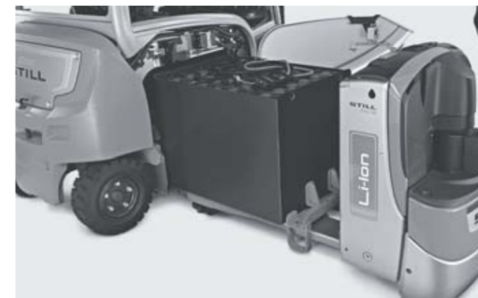
Substituição da bateria com porta-paletes elétrico
